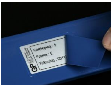
Foto 2: gebruik identificatielabels die zowel de voorbehandeling als het poedercoaten doorstaan.
