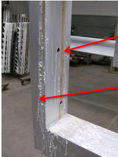
Foto: slecht resultaat na droging van de chemische voorbehandeling omwille van onvoldoende drainagegaten
