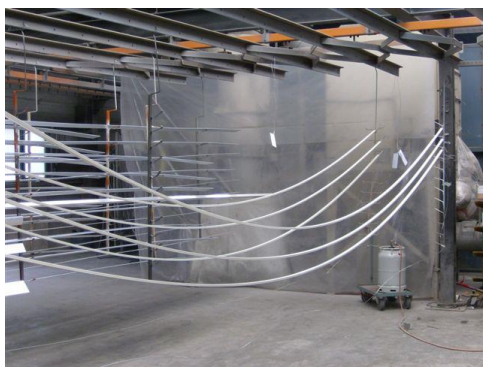
Foto: doorhangen van de stukken ten gevolge van het niet aanwezig zijn van voldoende ophangpunten. Gevolg is rendementsverlies, kans op het uit de haak vallen van de stukken, beschadigingen en hogere kostprijs.
